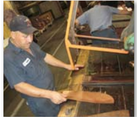
Erst beim Glanzstoßen an der Glanzstoßmaschine entsteht der Cordovan-typische Glanz.
