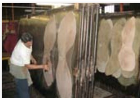
Zum Trocknen wird das Shell auf Glasscheiben aufgebracht.
